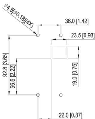
Размер и расположение отверстия (мм)
