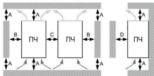
Рис. 3. Горизонтальная и вертикальная установка нескольких ПЧ
