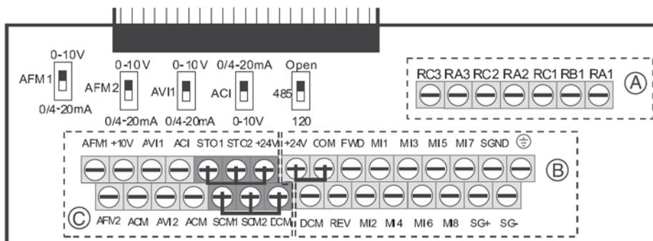
На рис. выше по умолчанию установлены переключки STO1/STO2/+24V и SCM1/SCM2/DC. По умолчанию для дискретных входов установлен режим NPN (SINK), т.е. установлена переключка на клеммах +24V и COM ; Подробнее см. Варианты подключения NPN / PNP в главе «Подключение».
