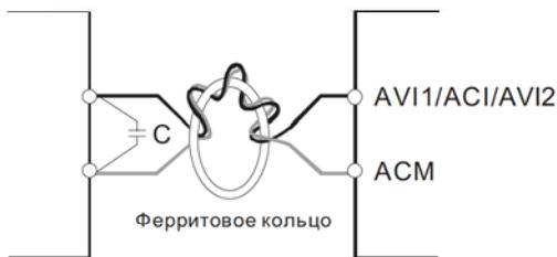
При этом каждый из сигналов подключать отдельной экранированной парой. Не рекомендуется использовать один общий провод для разных сигналов. Аналоговые и цифровые сигналы следует подключать отдельными экранированными кабелями.
