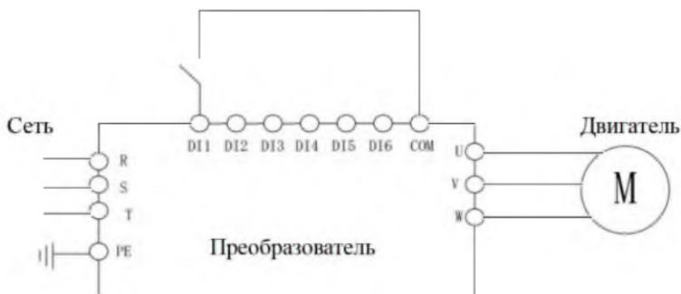
Рис. 4-2 Управление пуском и остановом преобразователя.
