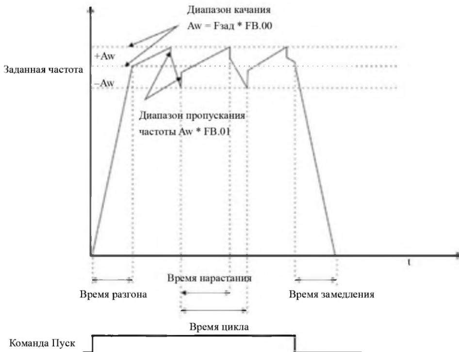
Рис. 6-23 Работа с качающейся частотой
